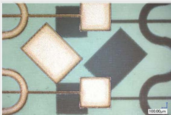
LPKF ProtoLaser R4 加工薄膜双面线路
