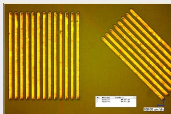
生物相容性材料如 LCP 和 COC, 表面薄膜电路金层制作, 线宽小于 50 微米
