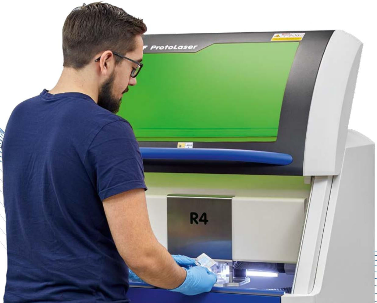
快速电路板制作系统结构紧凑, 所需实验室空间面积小。而工业上多步骤的化学腐蚀过程占地空间大, 费用高, 对化学药液有监控和后期处理的要求, 且对职业健康和安全性都有着更高的挑战。
