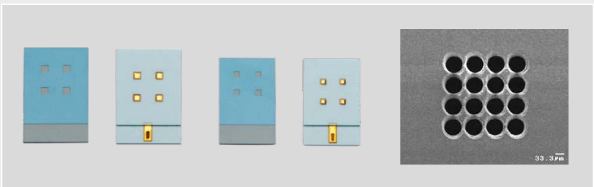
柔性 LTCC 零部件: 紫外激光可以在敏感基材上进行切割、刻划和钻孔
