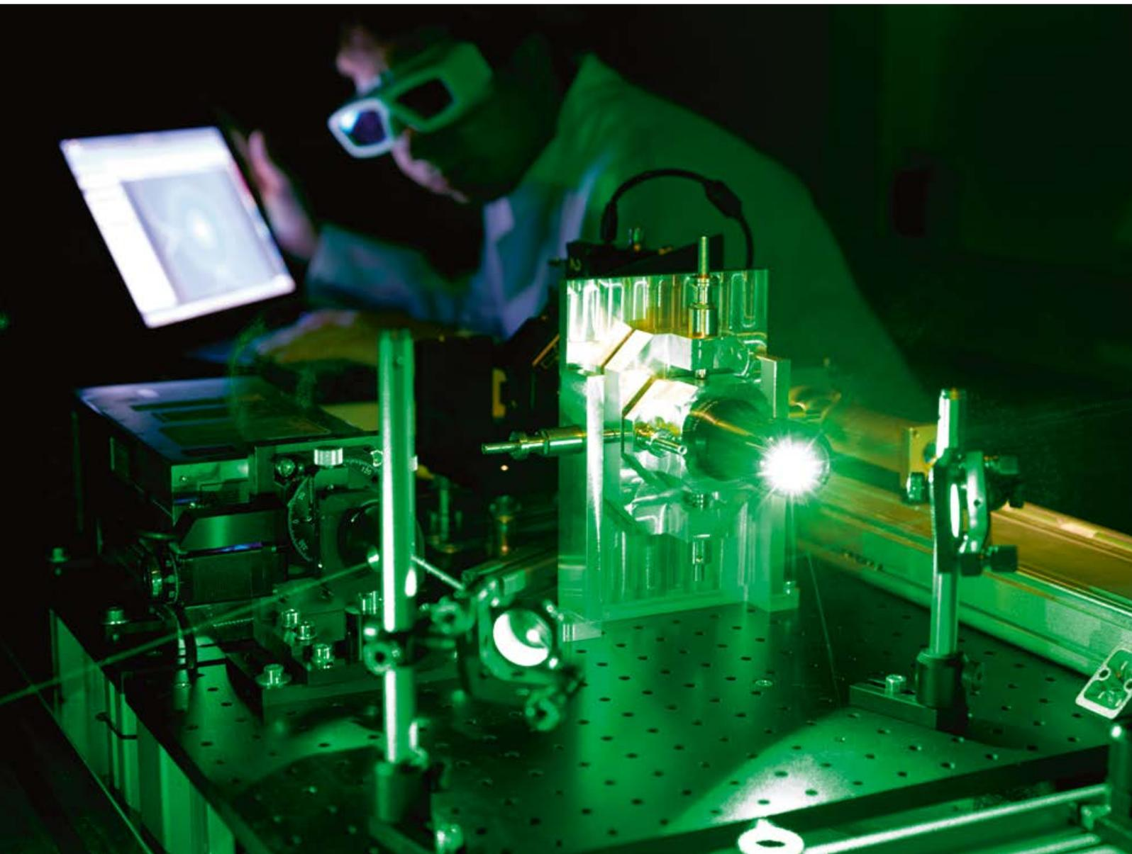
薄膜太阳能模组激光划线系统
